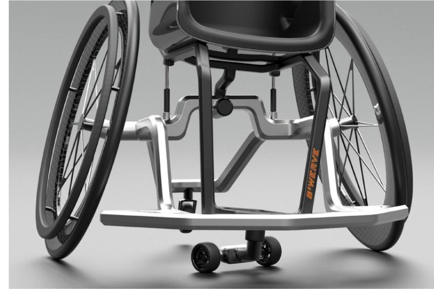
Vorn: Lenkbewegung: Steuerachse mit den beiden kleinen Lenkrädern dreht sich bei Neigung des Sitzes.
