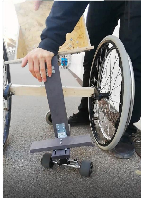
Mithilfe von Druck (eigentlich durch die Gewichtsverlagerung) wird die Vorderachse gesteuert da sie in die Richtung gedrückt wird und somit eine Lenkung einleitet.
