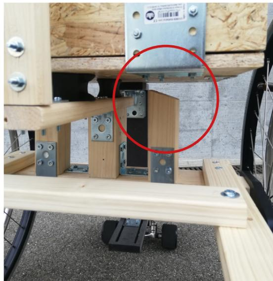
Zwei Stützräder und einen Schwenkanschlag unter dem Sitz sorgen für mehr Sicherheit und Stabilität auf dem Rollstuhl.
